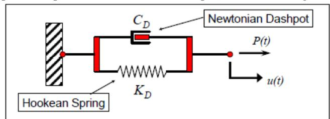
Fig. 6 KELVIN MODEL - VISCOELASTIC DAMPER [8]
