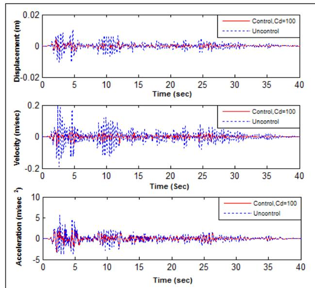
Fig. 10 TIME HISTORY RESPONSE AT FIRST STOREY UNDER EL CENTRO EARTHQUAKE EXCITATION
