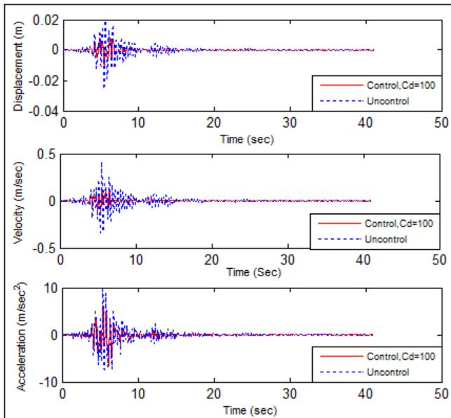
Fig. 11 TIME HISTORY RESPONSE AT FIRST STOREY UNDER KOBE EARTHQUAKE EXCITATION
